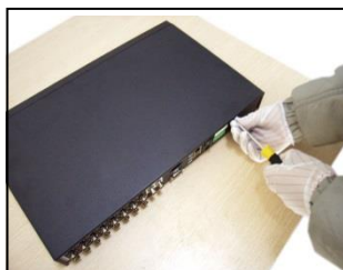
①拆卸主機上蓋的固定螺絲
