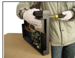
③安裝固定硬碟螺絲
