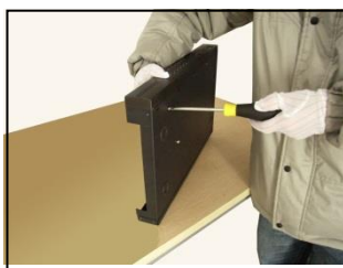
④安裝固定硬碟螺絲
