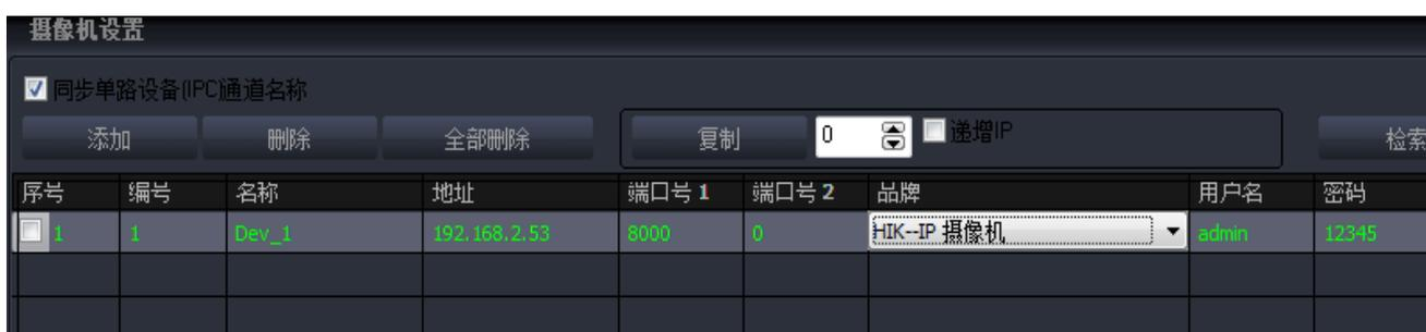
圖 2-9 設置攝像機設備的品牌
