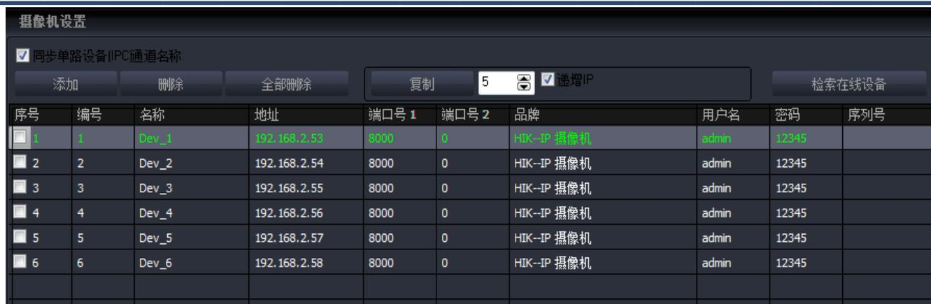
圖 2-11 使用【递增 IP】和【複製】功能添加已知 IP 位址的攝像機設備
