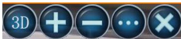
PTZ 的 3D 控制功能。在全景攝像機預覽畫面上打開 PTZ 之後，點擊
